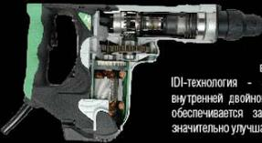
Новая линейка отбойных молотков Hitachi объединяет запатентованную IDI-технология, которая не только улучшила внешний вид изделий, но и заметно увеличила их ресурс. IDI-технология – это конструкция алюминиевого корпуса с внутренней двойной изоляцией из полиамида. Благодаря этому обеспечивается защита металлических элементов корпуса и значительно улучшаются изоляционные характеристики.
